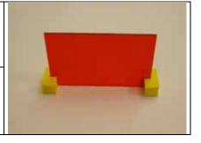
El Mira es un rectángulo de plástico transparente, que actúa como un espejo pero al mismo tiempo permite ver a través de él. Debes utilizarlo ajustado a los dos soportes verticales para conseguir que sea perpendicular al plano de trabajo.
