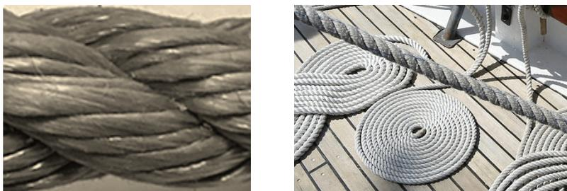
Figura 5: Cuerdas compuestas de hilos en espiral.
