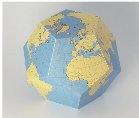
Figura 13. Globo terráqueo con forma de dodecaedro realizado con la proyección gnomónica
