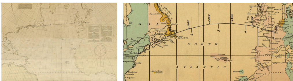
Figura 15. A la izquierda, carta de navegación (1926) de Charles Lindberg, realizada con la proyección gnomónica, en la que está marcada la ortodrómica (círculo máximo) que une Nueva York y París. A la derecha, trozo del Mapa de Mercator (1927) de Charles Lindberg, en que están marcadas las loxodrómicas (líneas de rumbo constante) entre algunos puntos que están en el círculo máximo (camino de mínima distancia) entre Nueva York y París
