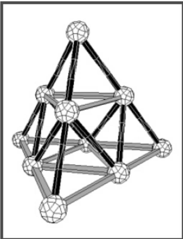
**El triángulo como refuerzo.** Una sección debe dedicarse a experimentar con el peso y la rigidez. El objetivo de estos experimentos debe ser enseñar a los alumnos que deben incorporar refuerzos triangulares en sus puentes. Los refuerzos pueden, por supuesto, construirse con el Sistema Zome (“Teselas triangulares tridimensionales”).
