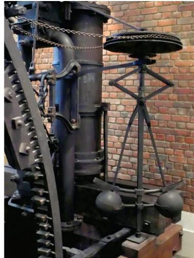
Figura 4: Péndulo centrífugo.
